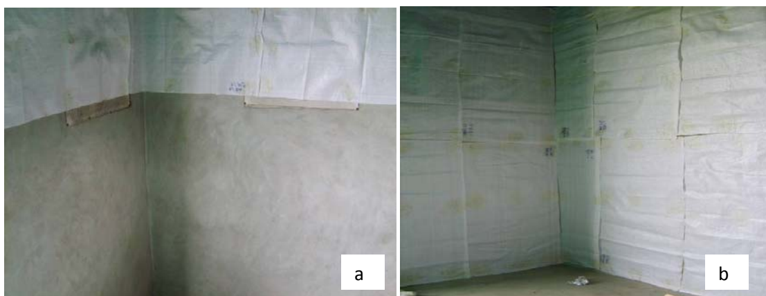
Photo 2-3 : Mur de case expérimentale couvert au 1/3 (a) et complètement (b) avec le polypropylène tissé imprégné de bendiocarb à la dose de 200 mg/m 2
